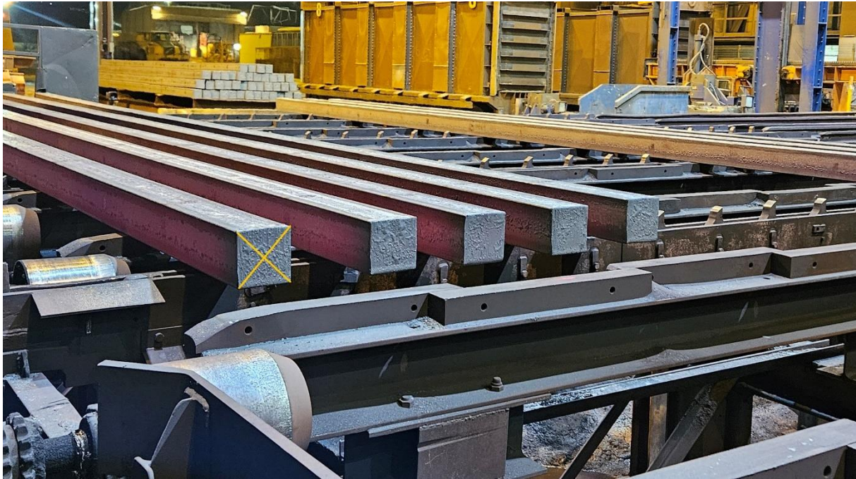
Bilde 1 – Bilde av en billets på 160x160mm. Krysset viser hvilke diagonaler som skal måles.
